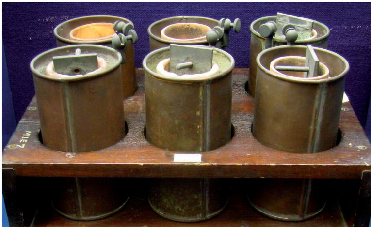
Das Daniell-Element wurde 1836 von John Frederic Daniell erfunden und besteht aus zwei Halbzellen. In einer Halbzelle taucht ein Zinkblech in eine Zink(II)-Ionen-Lösung und in der anderen ein Kupferblech in eine Kupfer(II)-Ionen-Lösung.
