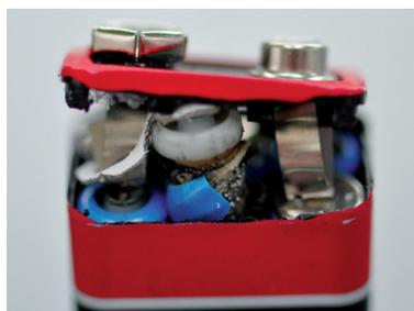
Auf diese Art sind die 4,5-Volt-Flachbatterie und der sogenannte 9-Volt-Block verwirklicht, denn sie enthalten drei bzw. sechs Zink-Mangandioxid-Elemente, die in Reihe geschaltet sind.
