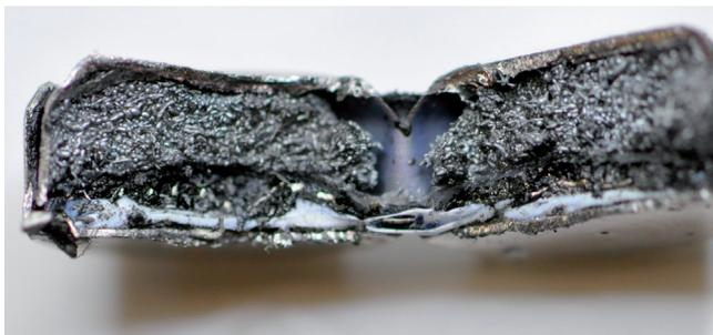
Abb. 12: Aufgesägte Zink-Luft-Knopfzelle
