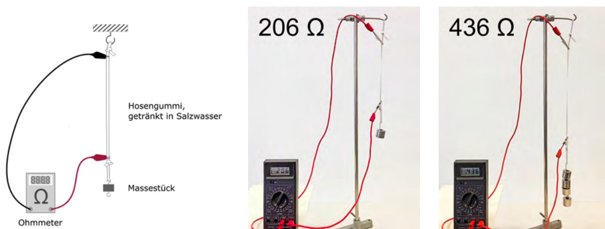
Abb. 13: Demonstrationsexperiment Dehnungsmesstreifen
