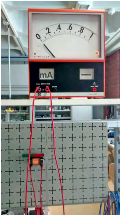
Abb. 19: Induktiver Sensor – Aufbau
