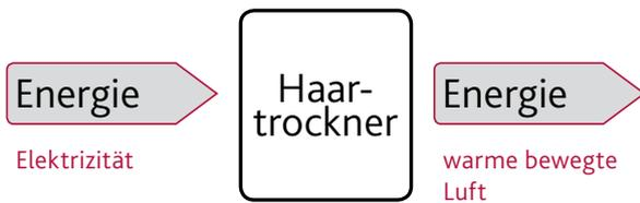
„Die Energie auf dem Träger Elektrizität wird im Haartrockner umgeladen auf die Träger Wärme und Bewegung (der Luft).“
