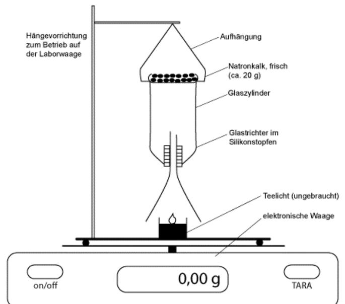
Fertigapparatur „Schwere Flamme“ für Wäageexperimente mit einem brennenden Teelicht
